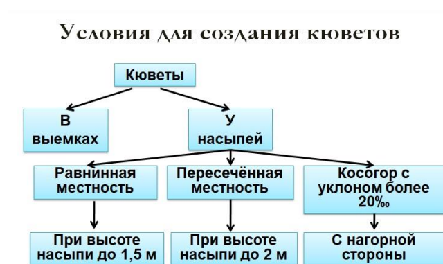
Рисунок 1 – Случаи устройства кюветов у земляного полотна
