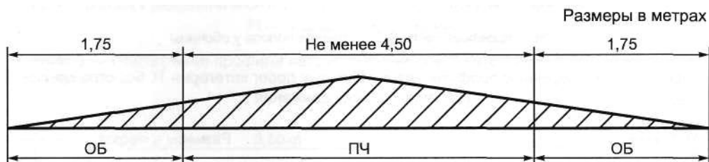
Рисунок 11 - Поперечные профили автомобильных дорог категории IV без ограждений
