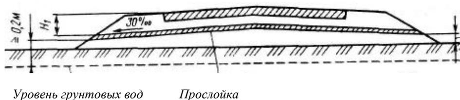
Рисунок 6.5 – Конструкция влагоизолирующей прослойки
